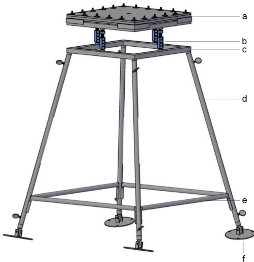
Figura 7. Vista completa de la estructura. (a) depósito de agua; (b) tornillos de nivelación; (c) base inferior; (d) patas telescópicas; (e) traviesas; (f) plataforma articulada de apoyo.
