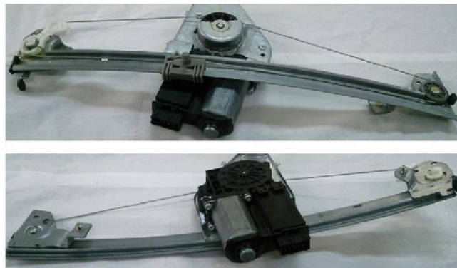
Figura 7.45. Mecanismo de cable y polea del elevallunas eléctrico.
